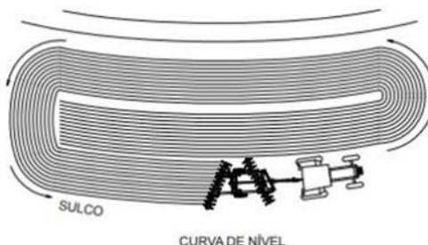
*Figura 03 – Gradagem em nível. (Em terreno com curva de nível é usual começar dois talhões de cada vez, tendo-se o cuidado de iniciar o trabalho com a curva de nível do lado esquerdo do tratorista. Quando chegar no meio da curva de nível, convém começar outro talhão para diminuir o gasto de combustível).*
